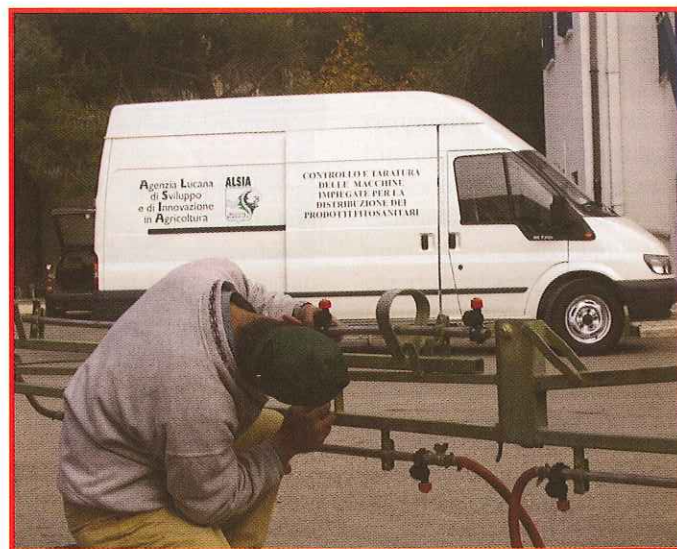
[ Taratura. Un laboratorio mobile per gli interventi sulle irroratrici
