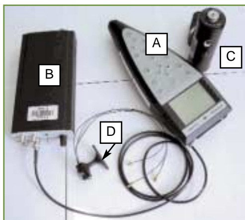
Fig. 2 - Esempio di catena strumentale portatile per il rilievo delle accelerazioni al sistema mano-braccio. A sistema di acquisizione - B modulo per le vibrazioni - C calibratore per accelerometri - D accelerometri con adattatore al sistema mano-braccio.
