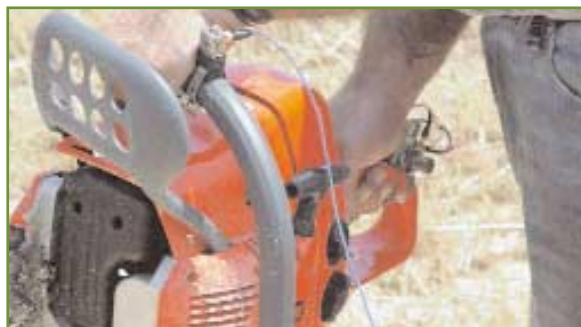
Fig. 6 - Accelerometri triassiali montati, con un adattatore, sulle impugnature di un decespugliatore e di una motosega.
