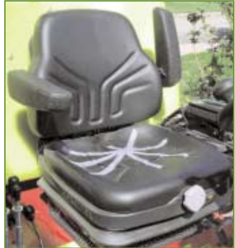
Fig. 9 - Sedile di un un rasaerba semovente con l'accelerometro triassiale a cuscino.
