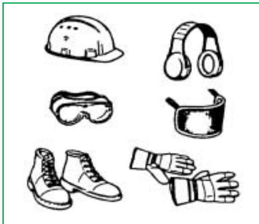
Fig. 10 - Dispositivi di Protezione Individuale per chi opera con le cesoie (pneumatiche, oleodinamiche o elettriche), ed in funzione dei particolari ambienti di lavoro: casco, cuffie, occhiali, visiera, scarpe antinfortunistiche, guanti.
