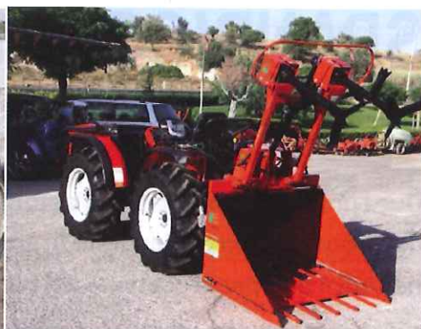
■ Spandicompost compatto autocaricante con distributore a velocità variabile.
