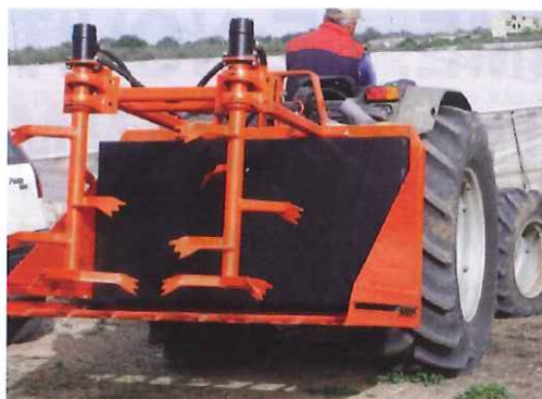
■ Spandicompost compatto autocaricante con distributore a velocità variabile.
